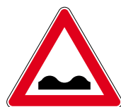
F.R 190 001 strada deformata
